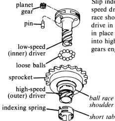
BENDIX RED BAND 2-SPEED COASTER BRAKE DISASSEMBLY AND ASSEMBLY SUBASSEMBLIES (cont.)
